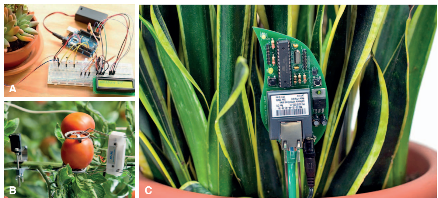
FIGURA 2 - Oggetti IoT per le piante. A) progetto Potted Plant Protector [FONTE: BOB HUMBOLDT, HUMBOLDT MICROCONTROLLERS GROUP]. B) Sensori Phytech per le piante di pomodoro [FONTE: PHYTECH, ISRAELE]. C) "Botanicalls kit" per la rilevazione del livello di umidità. Il sistema è programmato per inviare un Tweet sul dispositivo mobile per segnalare la necessità di innaffiare. [FONTE: BOTANICALS KIT DI SPARKFUN].
