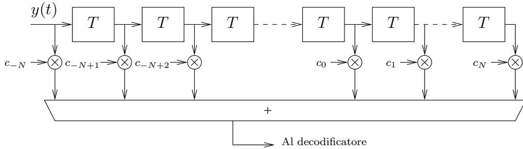
Figura 1: Equalizzatore lineare a coefficienti variabili con  $2N + 1$  prese.
