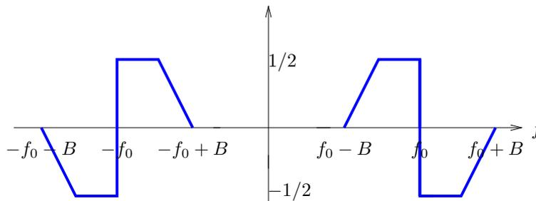
Sommando infine i due termini otteniamo lo spettro di figura, dal quale si deduce che lo schema a blocchi presentato effettua una modulazione SSB-LB.
