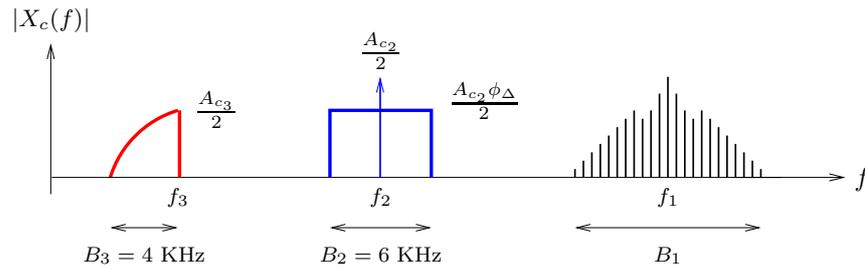
Figure 2: Spettro del segnale modulato  $x_c(t)$ , presentato per  $f \geq 0$ .
