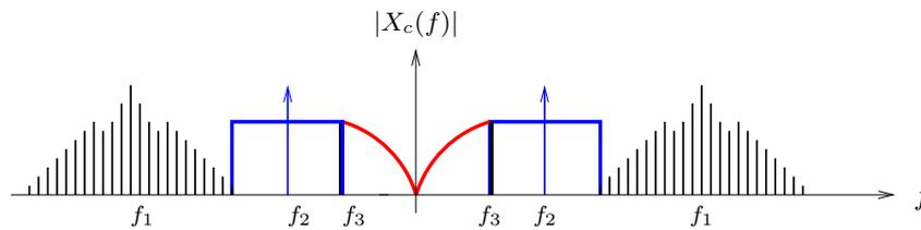
Figure 3: Spettro del segnale  $x_c(t)$  con minima banda occupata.
