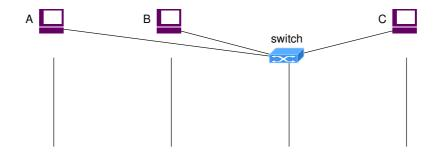
8) Nel seguente schema di rete indicare una possibile sequenza di messaggi di un attacco di ICMP spoofing di tipo ICMP redirect da parte del nodo C (attaccante) che tenta di fare un Man In The Middle tra A (vittima) e B. Si consideri il caso in cui A e B si vogliano scambiare i seguenti 4 pacchetti IP: pkt1:A→B, pkt2:B→A, pkt3:A→B, pkt4:B→A, e l'attacco avvenga sull'invio del primo pacchetto (pkt1).
